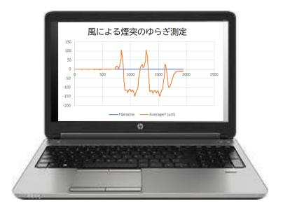
煙突に貼付けた格子をビデオカメラで撮影するだけで、 上下左右方向の変位測定が可能。
